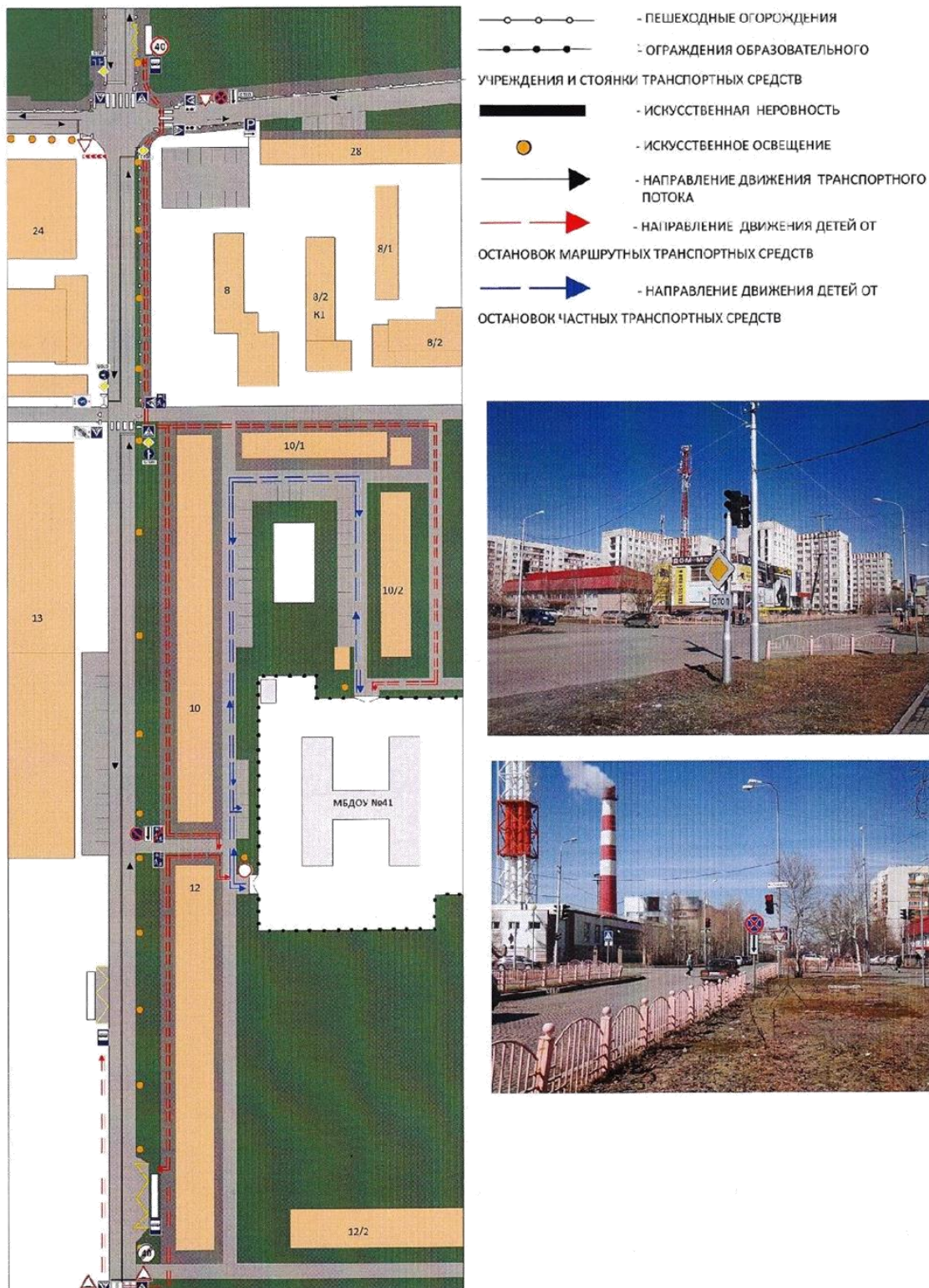
2. СХЕМА ОРГАНИЗАЦИИ ДОРОЖНОГО ДВИЖЕНИЯ В НЕПОСРЕДСТВЕННОЙ БЛИЗОСТИ ОТ МБДОУ №41 "РЯБИНУШКА" С РАЗМЕЩЕНИЕМ СООТВЕТСТВУЮЩИХ СРЕДСТВ ОРГАНИЗАЦИИ ДОРОЖНОГО ДВИЖЕНИЯ, МАРШРУТОВ ДВИЖЕНИЯ ДЕТЕЙ (ВОСПИТАННИКОВ) И РАСПОЛОЖЕНИЕ ПАРКОВОЧНЫХ МЕСТ
